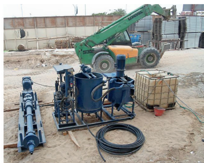
Photo 11.03-1. Équipements d'un atelier : malaxeur et pompe à injection
