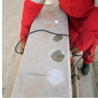
Fig. 6.06-2. Positionnement des transducteurs sur les faces opposées (méthode directe)
